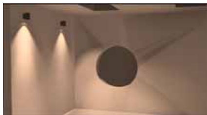
壁面に円形の窓を開口し、四辺形面分割なしで、ラジオシティメッシュを適用
